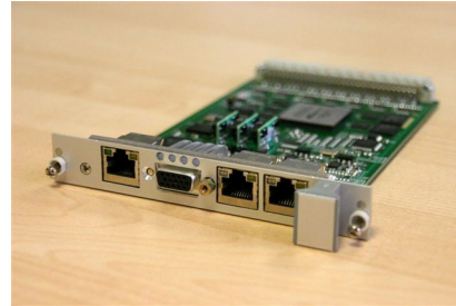
Carte Arion-Network pour le Module Arion-IO (Doc. Arion Entreprise)
